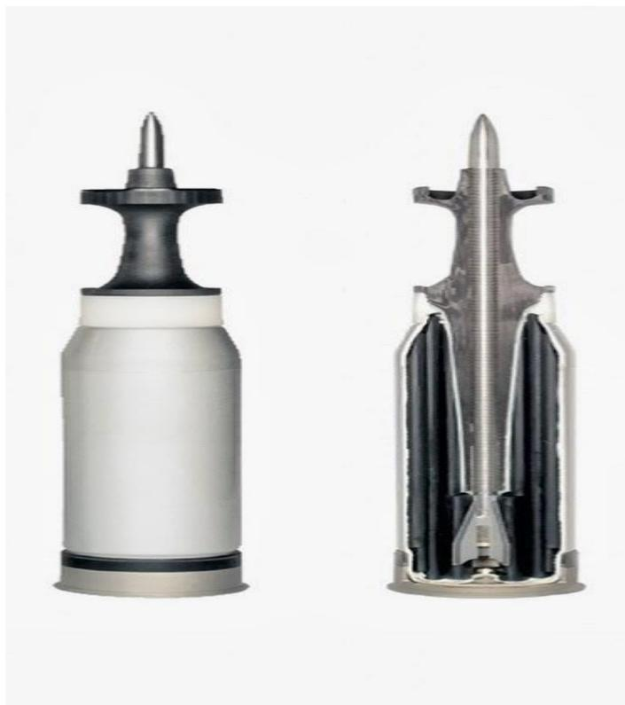
**Figura 10.** Modelo 3D de uma munição de urânio empobrecido.
