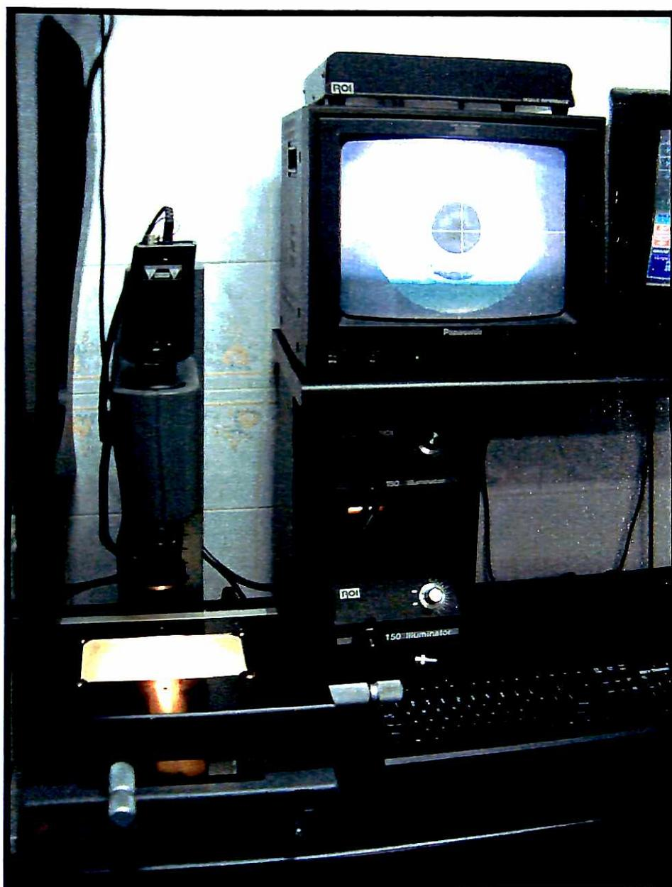
Figura 4.6 - Microscópio utilizado para confecção dos desenhos digitalizados dos corpos de prova ( OPTICAL MEASUREMENT INSPECTION SYSTEM ).
