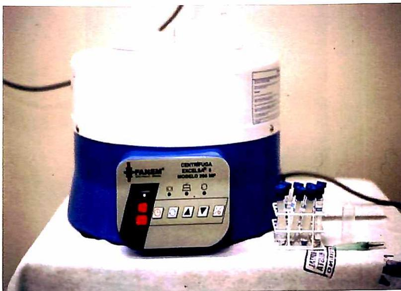
Figura 7- Centrifuga Fanem 260 microprocessada utilizada no experimento. Observar o sistema de tubos a vácuo e os coletores.
