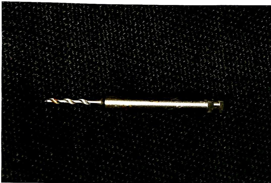
Figura 4: Fresa de 1,1mm
