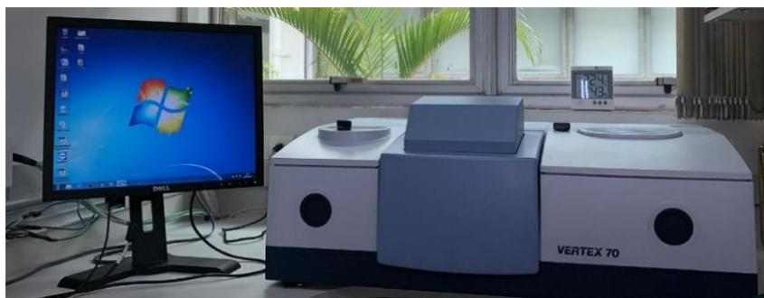
Figura 3: Aparelho FTIR, VERTEX 70.
