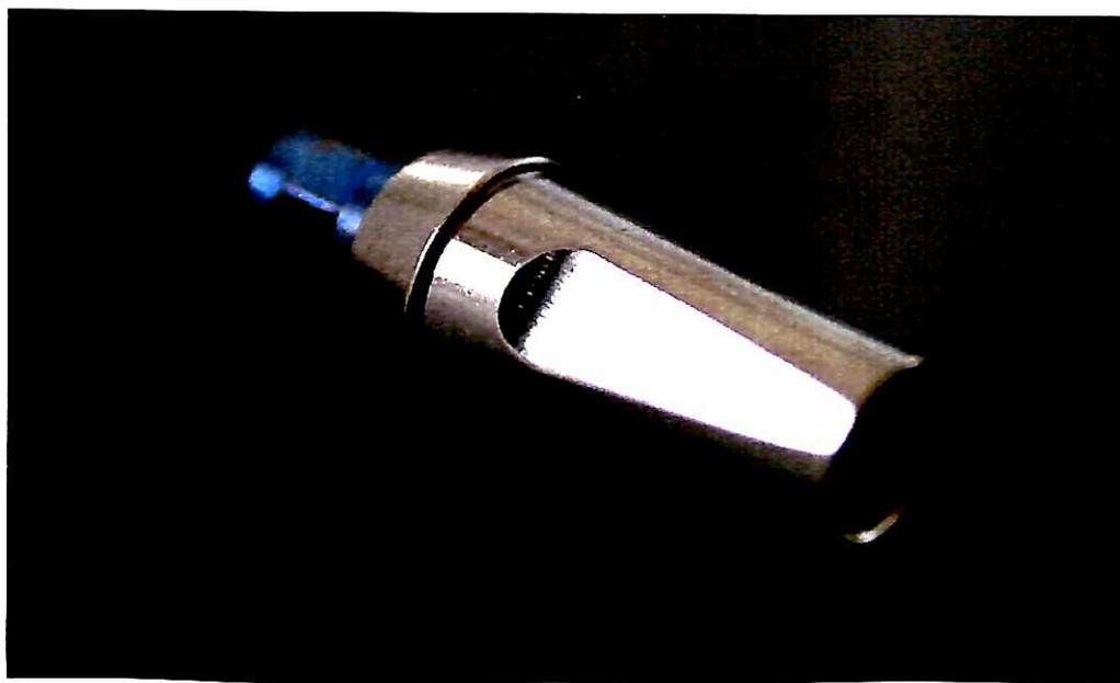
Figura 32: Chanfro existente em todas as amostras
