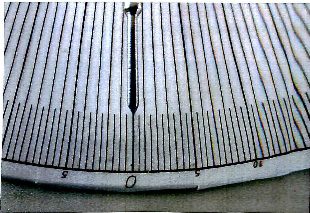
Figura 37: Dispositivo zerado em graus
