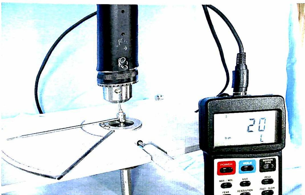
Figura 40: Torquimêtro posicionado, indicando o valor adequado para cada amostra
