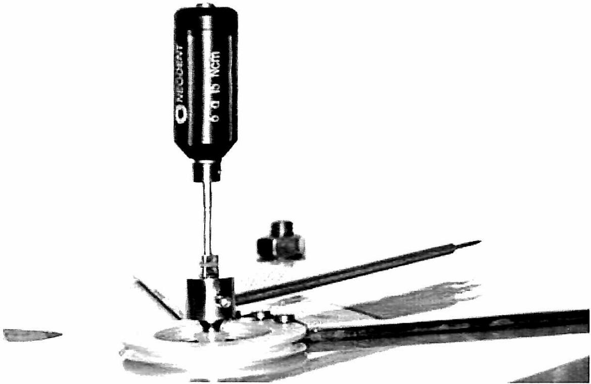
Figura 35: Chave calibrada em 5 N.cm
