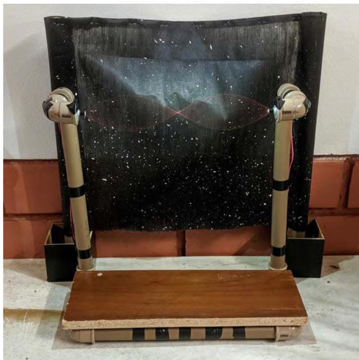
Figura 4 - Máquina de ondas estacionárias ligada
