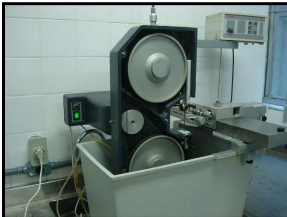
Figura 15 – Aparelho EXAKT® 300 CP utilizado para corte dos blocos
