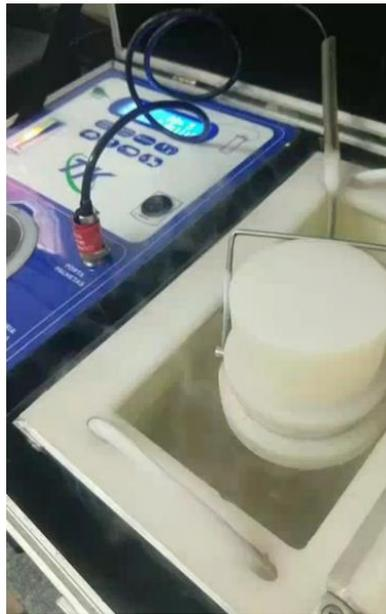
**Figura 5** - Equipamento TK 4000® empregado para refrigeração e congelação de sêmen.
